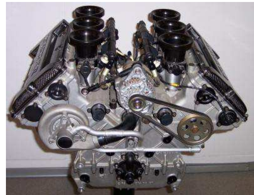
Ein Mercedes-V6-Rennmotor aus der DTM (Quelle:Wikipedia)
